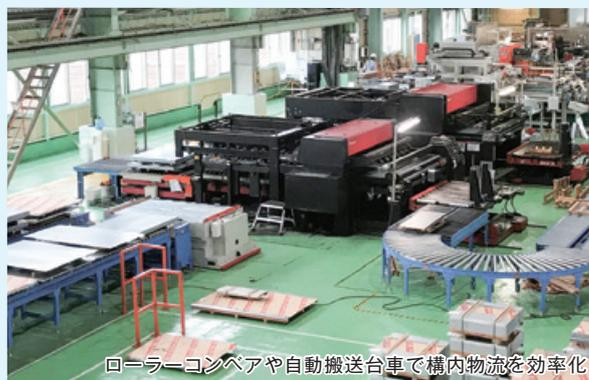
ローラーコンベアや自動搬送台車で構内物流を効率化
