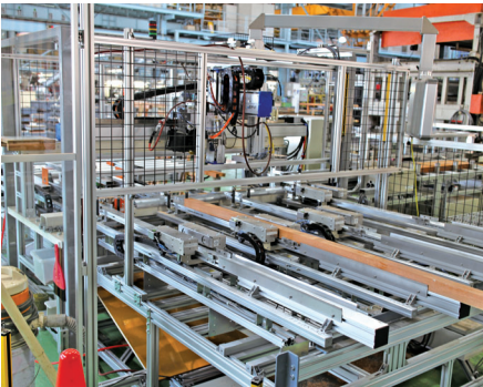
スキッドの組み立て工程を自動化する量産機
